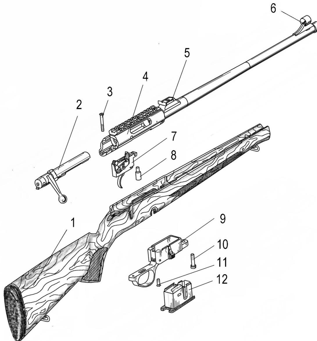
1 – ложа ВПО-193.06.00; 2 – затвор ВПО-215.02.00; 3 – винт задний ВПО-193.00.03; 4 – коробка ствольная со стволом ВПО-215.01.10; 5 – целик ВПО-105.01.06; 6 – мушка ВПО-105.01.03; 7 – механизм спусковой ВПО-193.03.00; 8 – винт опорный ВПО-193.00.01; 9 – приемник магазина ВПО-193.04.00; 10 – винт передний ВПО-193.00.02; 11 – винт средний ВПО-193.00.04; 12 – магазин ВПО-215.05.00.
